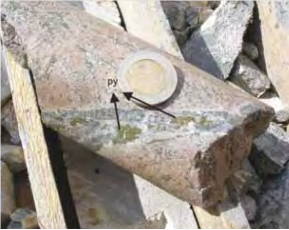
Şekil 13. Altere andezitte şeffaf kuvars damarı içinde pirit mineralleri (Örnek No: BG-32).
